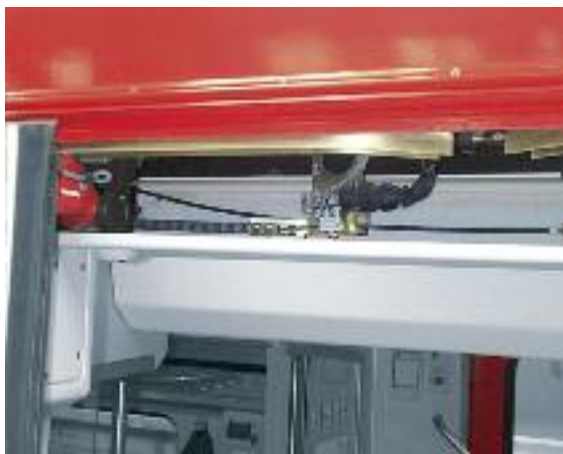
E2 mini Energy Chain® in a tooling machine, coolant resistant
