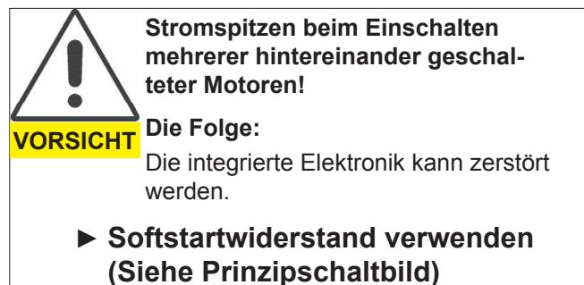
Beim Einschalten einer Vielzahl von Antrieben muß der Einschaltstrom über eine Softstartfunktion realisiert werden. Das kann entweder durch entsprechende Wahl eines Netzteiles oder wie im nachfolgenden Prinzipschaltbild erfolgen.
